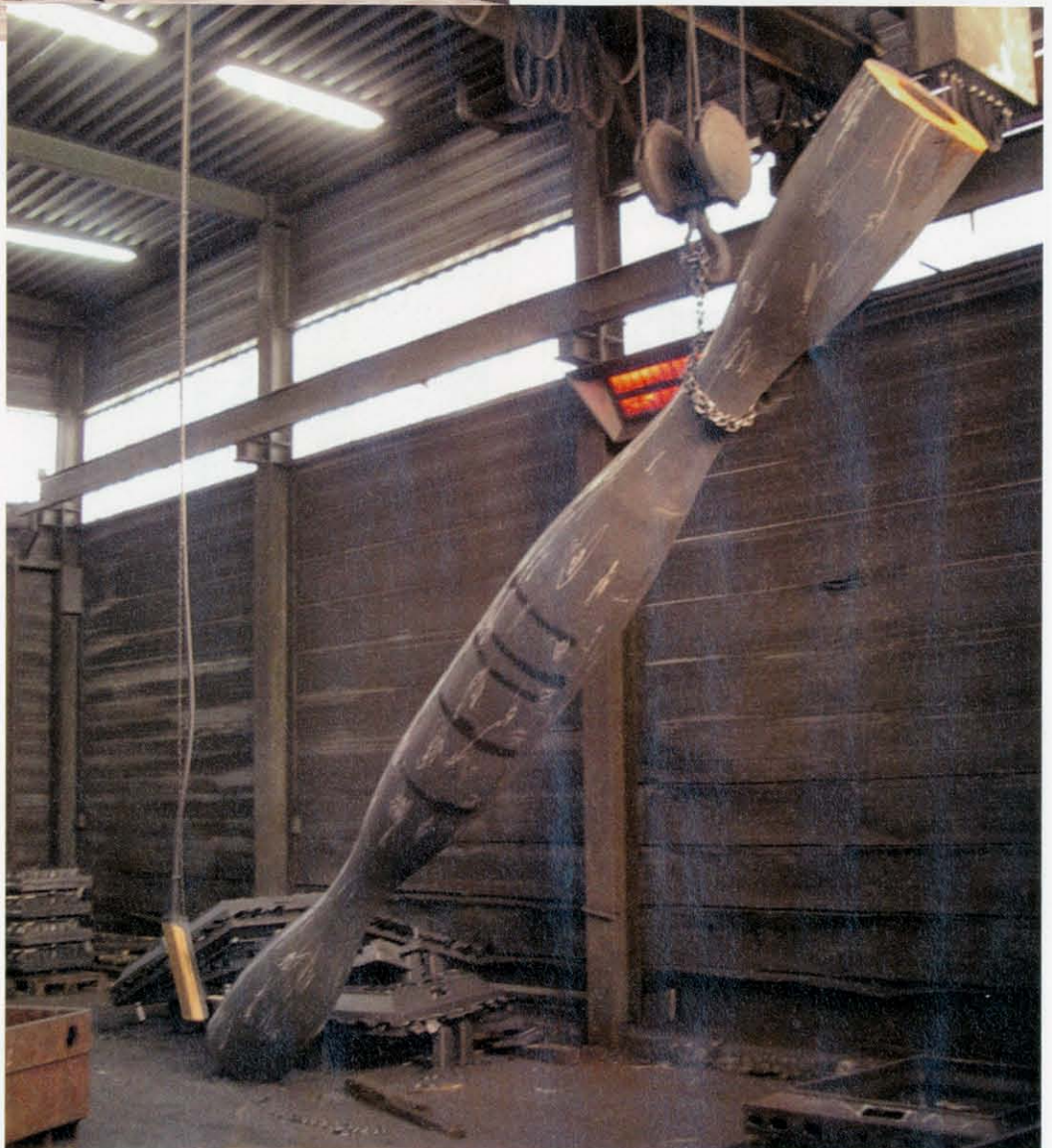
Een proefgietstuk van een gietijzeren kolom.
